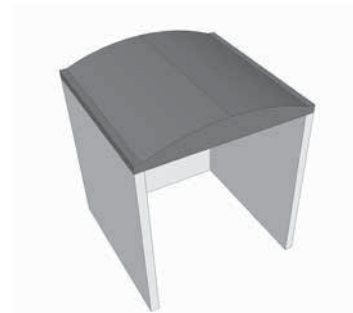
Soffitto a botte Toit en dôme Barrel vault ceiling
